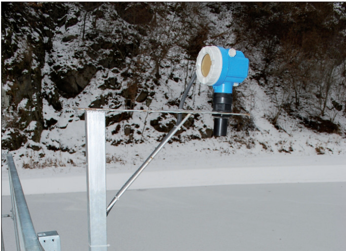
Rys. 8 Czujnik poziomu zainstalowany na tamie
