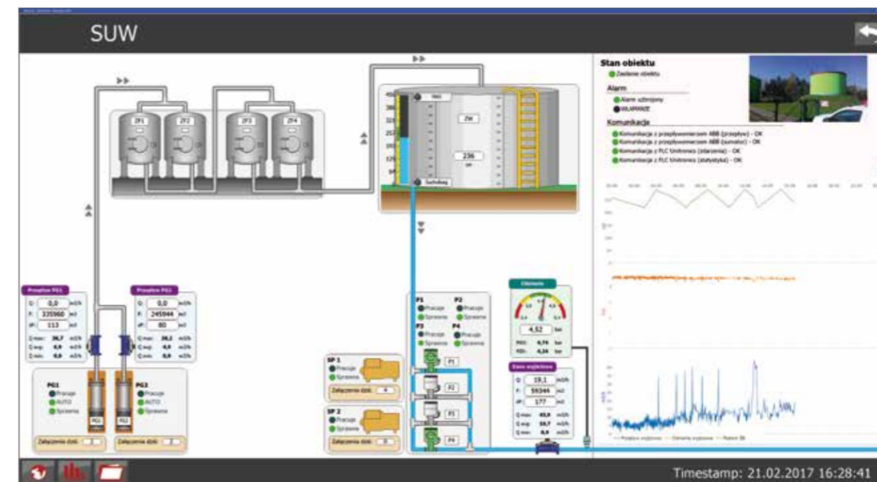
Poniżej widok tzw. dashboard'u stworzonego w systemie SCADA Movicon, który w sposób czytelny prezentuje operatorowi zestawienie najważniejszych parametrów monitorowanych obiektów wraz z informacją o alarmach.
