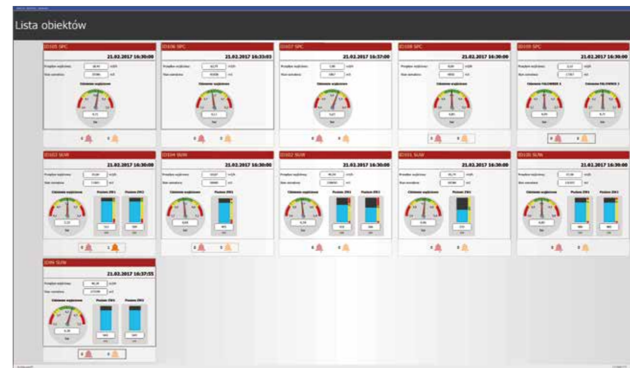
Poniżej widok tzw. dashboard'u stworzonego w systemie SCADA Movicon, który w sposób czytelny prezentuje operatorowi zestawienie najważniejszych parametrów monitorowanych obiektów wraz z informacją o alarmach.
