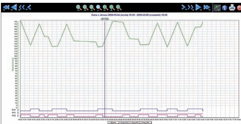
Wykresy zmian poziomu wody w zbiorniku retencyjnym, cykle pracy pomp głębinowych oraz sieciowych
