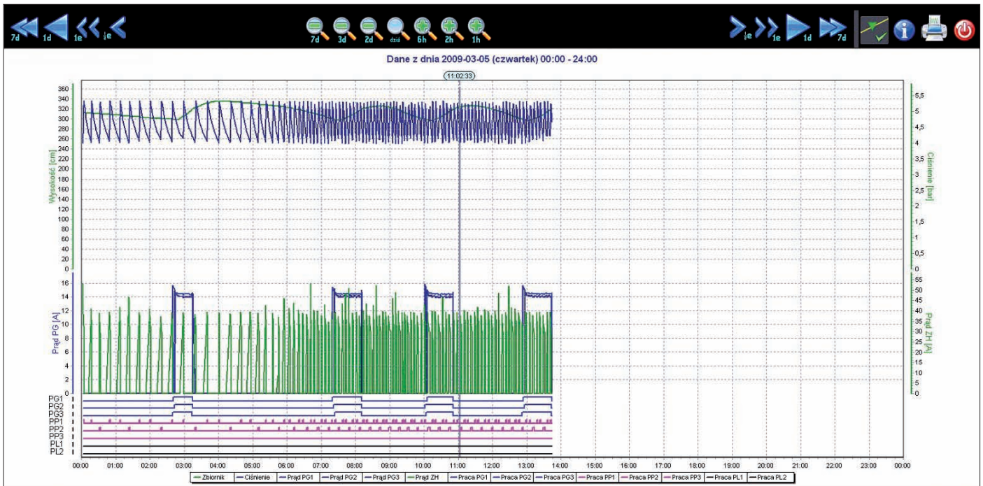
Wykresy obrazujące cykle pracy pomp, zmiany poziomu i ciśnienia na wyjściu ze stacji
